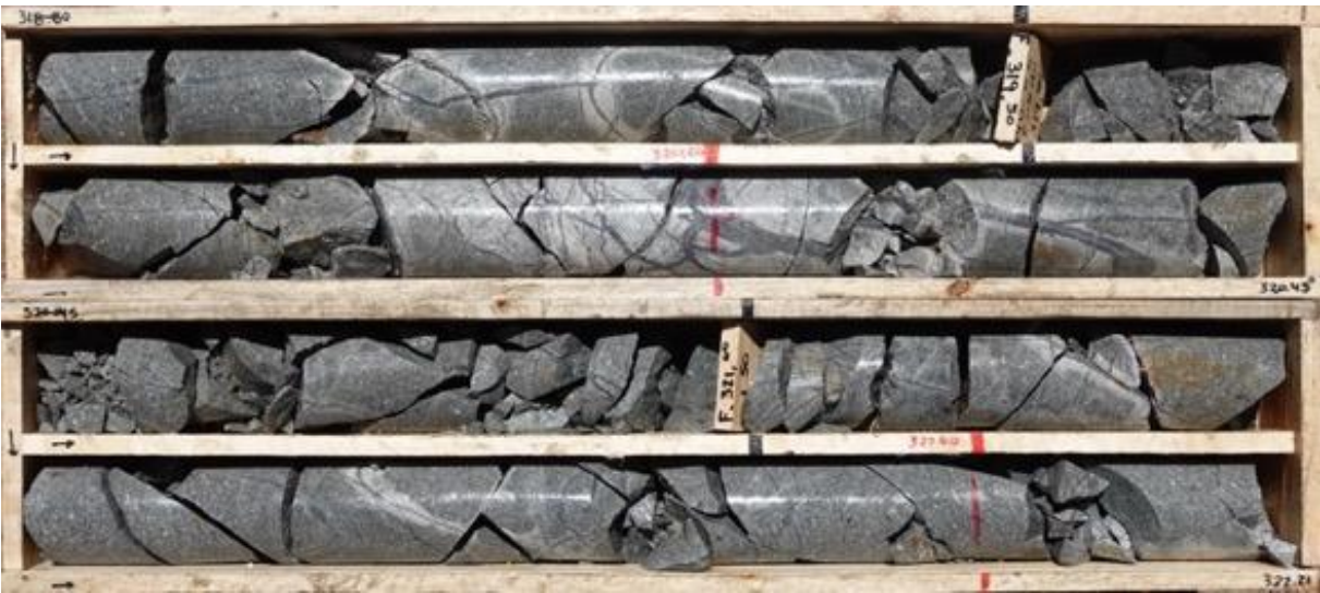
Hole PIU06: Chalcopyrite-chalcocite-pyrite sulfide assemblage
